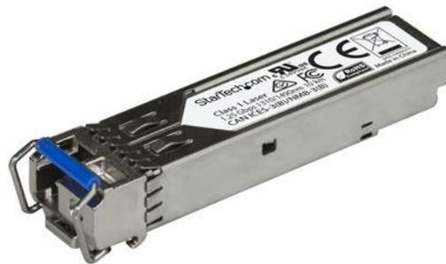
Der SFPGE10KT3R5 ist ein Juniper SFP-GE10KT13R15-kompatibles Glasfaser SFP-Transceiver-Modul, das für den Einsatz mit Juniper® Marken-Switches und -Routern entwickelt, programmiert und getestet wurde. Es sorgt für zuverlässige 1 GbE-Konnektivität über Glasfaser-Kabel für 1000Base-BX10-U-konforme Netzwerke mit einer maximalen Entfernung von bis zu 10 km.
