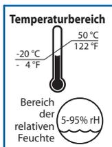
• Empfohlene Lagertemperatur für den Computerwagen: 25 °C. Bei dieser Temperatur ist der alterungsbedingte Kapazitätsverlust der Batterie verringert. Lagertemperatur: min. -20 °C und max. 50 °C. Der empfohlene Feuchtigkeitsbereich für die Lagerung liegt zwischen 5 % und 95 % RH.
