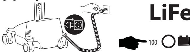
3 Schalten Sie die Stromversorgung aus, sobald die Batterie zu 100 % geladen ist. Schalten Sie die Stromversorgung ab, indem Sie den Hauptschalter 1 bis 3 Sekunden lang gedrückt halten. Die Betriebs-LED erlischt.
