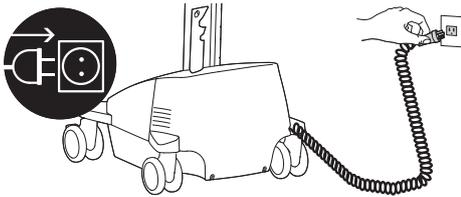
Ziehen Sie das Spiralkabel nicht mehr als 2,5 Meter in die Länge, da es sonst zu Schäden am Kabel kommen kann.
