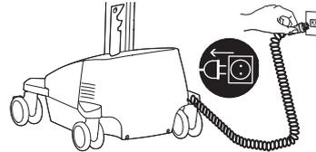
**c** Schalten Sie die Stromversorgung ab, indem Sie den Hauptschalter 1 bis 3 Sekunden lang gedrückt halten. Die Betriebs-LED erlischt.
