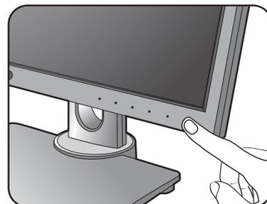
Schalten Sie den Computer an und wählen Sie eine Eingangsquelle über die OSD-Steuerungstasten aus.
