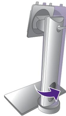
Entfernen Sie anschließend den Sockel vom Ständer.
