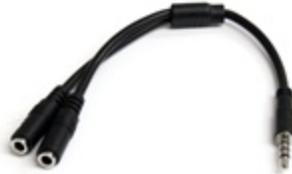
Der Kopfhörer-/Mikrofon-Combo-Splitter (4-pol. 3,5 mm auf duale 3 pol. 3,5 mm) MUYHSMFF verfügt über einen 3,5-mm-Stecker (TRRS) und zwei 3,5-mm-Anschlussbuchsen (TRS), mit denen Sie Ihren PC oder Laptop durch einen einzigen 3,5-mm-Audioanschluss um einen Mono-Mikrofon-Eingang sowie einen Stereo-Ausgang erweitern können.
