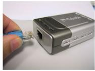
Stecken Sie ein CAT5-Ethernet-Kabel mit einem RJ-45-Stecker in die RJ-45-Buchse des DUB-E100.
