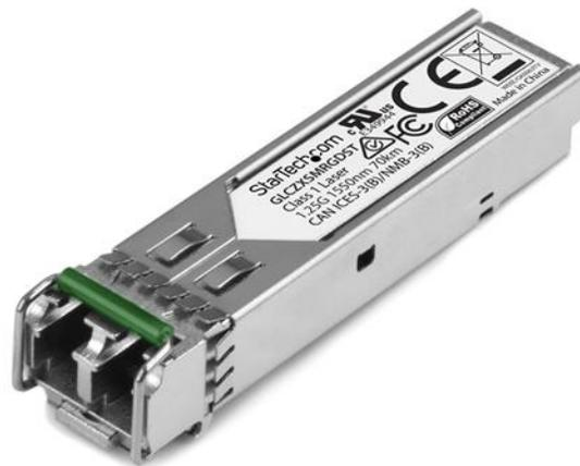
Das GLCZXSMRGDST ist ein Cisco GLC-ZX-SM-RGD-kompatibles Glasfaser-Transceiver-Modul, das speziell für die Zusammenarbeit mit Cisco®-Switches und -Routern entwickelt, programmiert und getestet wurde. Es liefert zuverlässige 1-GbE-Konnektivität über Glasfaserkabel für 1000BASE-ZX-konforme Netzwerke mit einer maximalen Entfernung von bis zu 70 km.
