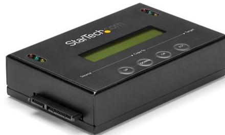
Mit der eigenständigen Festplatten-Kopierstation/-Löschstation SATDUP11 können Sie 1-zu-1 kopieren oder bis zu 2 SATA-Festplatten gleichzeitig ohne Host-Computer löschen.
