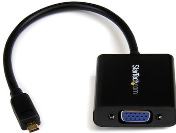
Der HDMI® Micro-auf-VGA-Adapter/-Konverter MCHD2VGAE2 konvertiert aktiv ein HDMI® Micro-Quellvideosignal von Ihrem Smartphone, Ultrabook oder Tablet-PC für einen VGA-Projektor oder ein VGA-Display.
