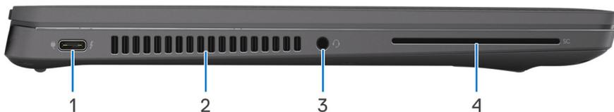
1. Thunderbolt 4.0-Anschluss mit Power Delivery und DisplayPort (1.4) Alternate-Modus
