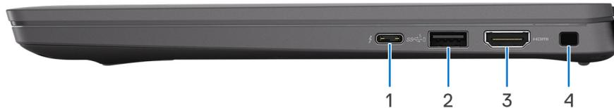
1. Thunderbolt 4.0-Anschluss mit Power Delivery und DisplayPort (1.4) Alternate-Modus
