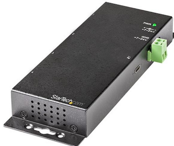
Mit diesem industriellen USB-Hub mit 4 Anschlüssen können Sie vier SuperSpeed USB 3.2 Gen 2 (10 Gbit/s) Peripheriegeräte an Ihren USB-A oder USB-C Computer anschließen. Der Hub verfügt über zwei USB-A und zwei USB-C Peripherieanschlüsse, jeweils mit einem Stecker mit Feststellschraube und einem industriellen Metallgehäuse, das ideal für raue Industrieumgebungen ist.
