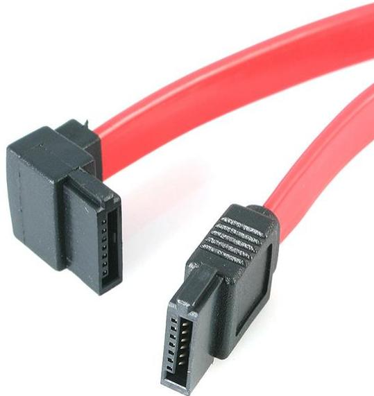
Das linksgewinkelte (90-Grad) SATA-Kabel SATA18LA1 verfügt über eine standardmäßige (gerade) SATA-Buchse und eine linksgewinkelte SATA-Buchse und bietet eine einfache 45 cm lange Verbindung mit einem Serial ATA-Laufwerk mit Unterstützung der vollen SATA 3.0-Bandbreite von bis zu 6 Gbit/s bei Verwendung mit SATA 3.0-konformen Laufwerken.
