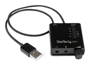
Mit der externen USB-Soundkarte ICUSBAUDIO2D können Sie Ihrem System über USB einen digitalen S/PDIF-Audioausgang und einen standardmäßigen 3,5-mm-Audio-/Mikrofonanschluss hinzufügen und so ganz praktisch eine interne Soundkarte umgehen oder ersetzen ohne das Computergehäuse zu öffnen.
