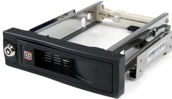
Mit diesem 3,5-Zoll-SATA-Festplatten-Hot-Swap-Einbauschacht können Sie ein 3,5-Zoll-SATA-Laufwerk in einen freien/unbenutzten 5,25-Zoll-Laufwerkeinbauschacht installieren. Zum Entfernen des Laufwerks muss einfach nur die Frontblendenklappe geöffnet werden. Zum Einsetzen eines Laufwerks wird es (mit den Anschlüssen voran) eingeschoben, bis sich die Klappe schließt.
