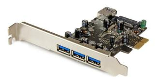
Das ist eine kostengünstige Lösung zum Hinzufügen von USB 3.0-Konnektivität zu einem Computer. Diese 4-Port-PCIe-USB 3.0-Karte bietet drei externe Anschlüsse und einen internen Anschluss für ultimative Verbindungsflexibilität.
